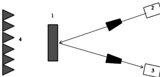
Рис. 1. Схема установки для измерения коэффициента отражения РПМ в свободном пространстве: 1-испытуемый образец; 2-передатчик; 3-приемник; 4-подложка из РПМ
