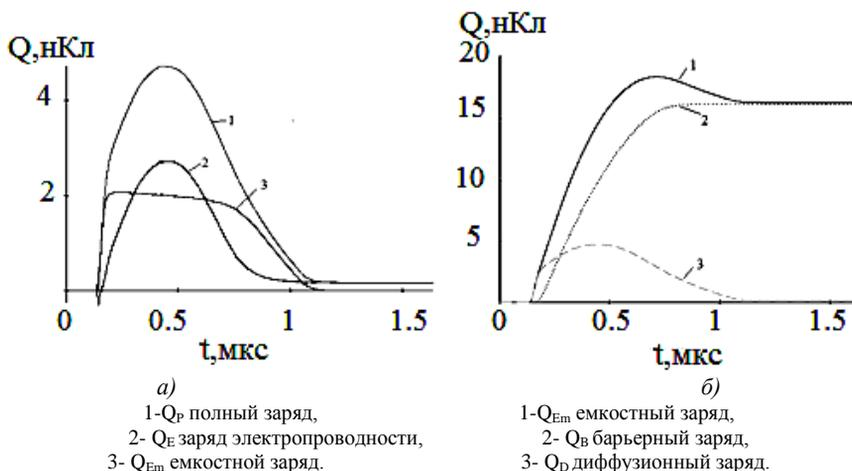
Рис. 3. График зависимости емкостного заряда  $Q_{Em}$  (а) и диффузионного заряда  $Q_D$  (б) от времени
