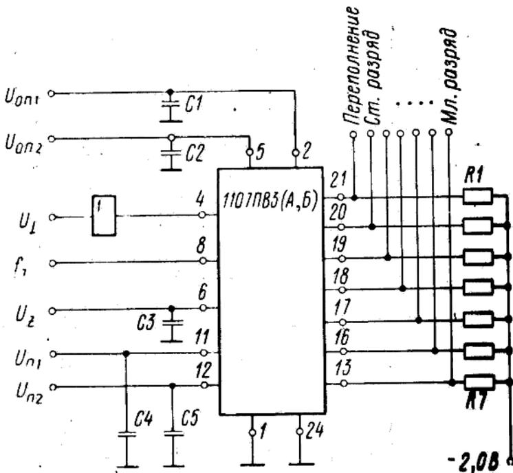
Рис. 1. Схема включения КР1107ПВ3 (А, Б)
