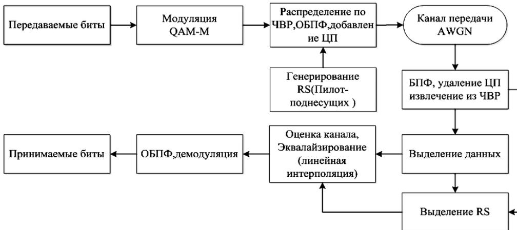
Рис. 1. Структура модели OFDM передатчика/приемника
