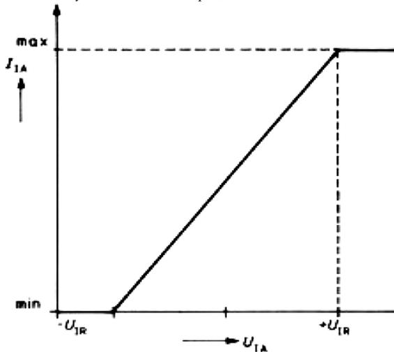
Рис. 2. Зависимость входного тока от входного напряжения
