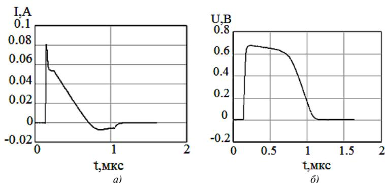
Рис. 1. График зависимостей напряжения (а) и тока (б) биполярного транзистора MJE18006 от времени, при измерении сверхкоротким импульсом
