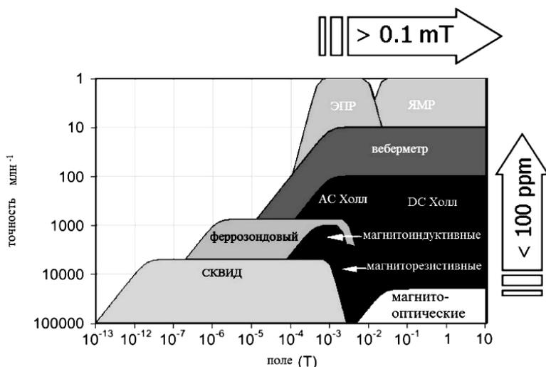
Рис. 1. Точность и пороги измерения магнитного поля разными методами
