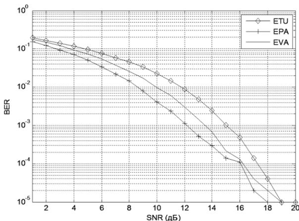
Рис. 2. Вероятность битовой ошибки в зависимости от SNR с эквалайзированием
