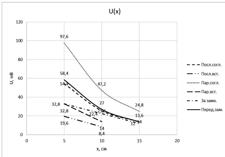
Рис. 3. График - Зависимость величины магнитного поля от расстояния
