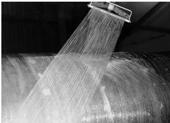
Рис. 2. Производство стекловолоконных труб спирально-кольцевой намоткой
