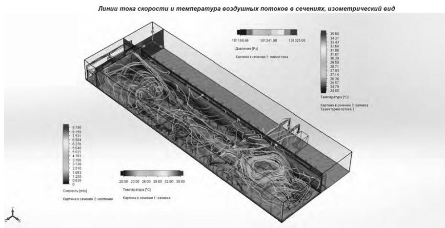
Рис. 13. CFD моделирования HVAC термического цеха
