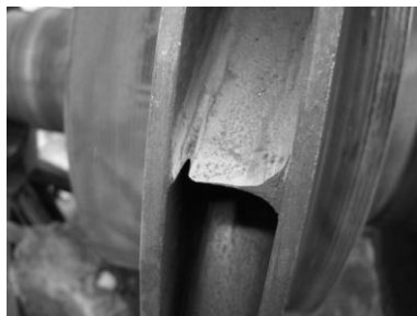
Рис. 1. Газо-абразивный износ лопаток рабочего колеса ротора центробежного нагнетателя
