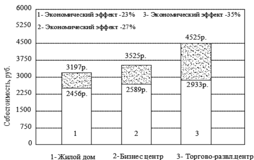
Рис. 4. Экономический эффект возведения монолитного каркаса на базе преднапряженного бетона
