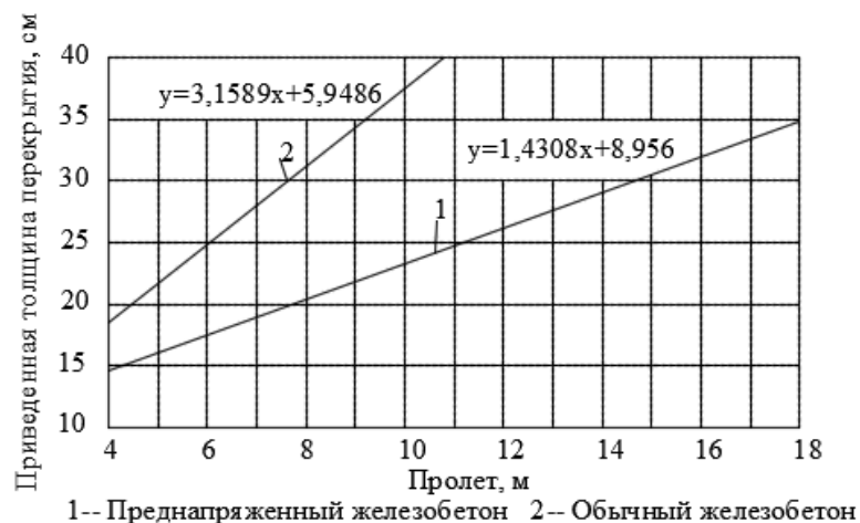
Рис. 1. Соотношение длины пролёта и толщины перекрытия в зданиях с применением обычного и преднапряженного железобетона
