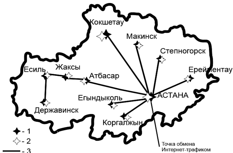
Рис. 2. Карта «Сеть постоянного и коммутируемого Интернет-доступа в Акмолинской области»; 1 – магистральные узлы мультисервисной пакетной сети; 2 – узлы постоянного и коммутируемого доступа мультисервисной пакетной сети; 3 – каналы STM1
