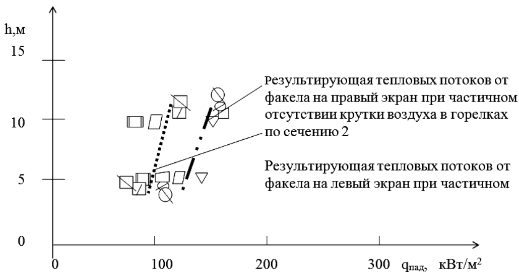
Рис. 6. Зависимость падающих потоков излучения факела q_{\text{пад}} от высоты точки h котла ТГМ-84А № 4 НкТЭЦ-1 по измерениям в сечении 2 при частичном отсутствии крутки воздуха в горелках (начало скатов холодной воронки соответствует отметке h=2 м):
