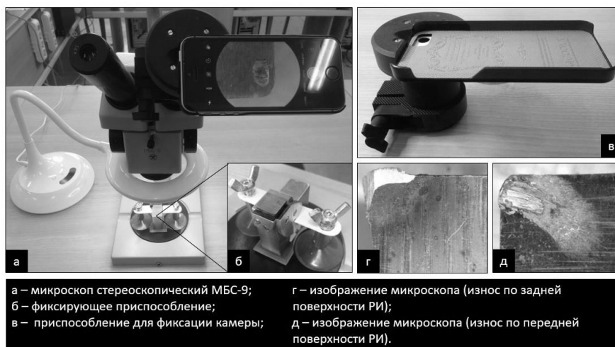
Рис. 2. Измерение износа режущего инструмента при помощи микроскопа МБС-9
