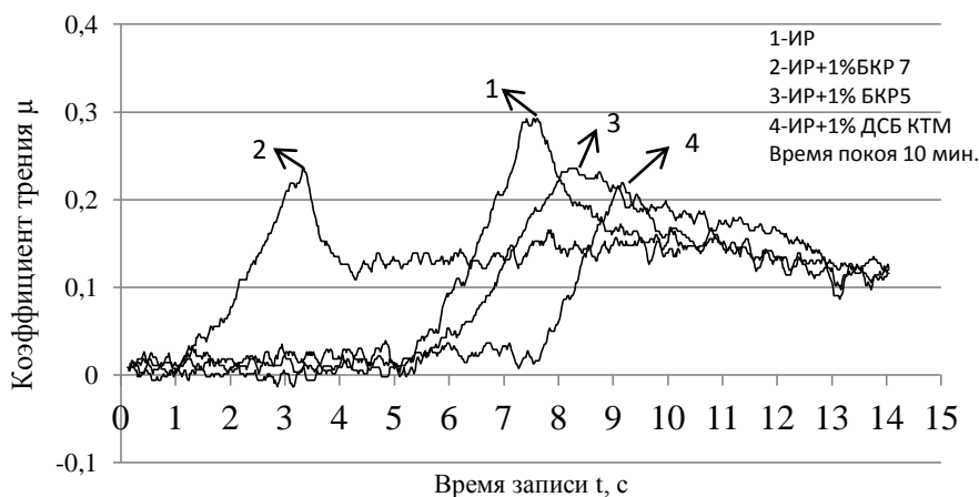
Рис. 2. Влияние смазочных добавок на коэффициент трения пары «сталь–корка»
