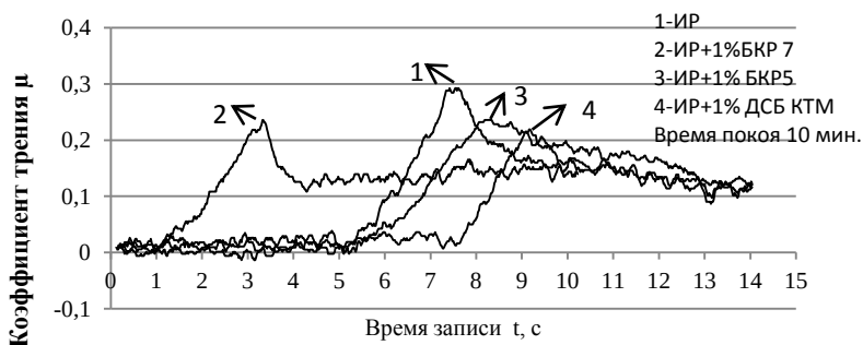
Рис. 2. Влияние смазочных добавок на коэффициент трения пары «сталь–корка»
