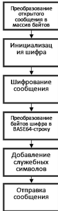
*Рис. 1. Схема защищенной передачи сообщения*
